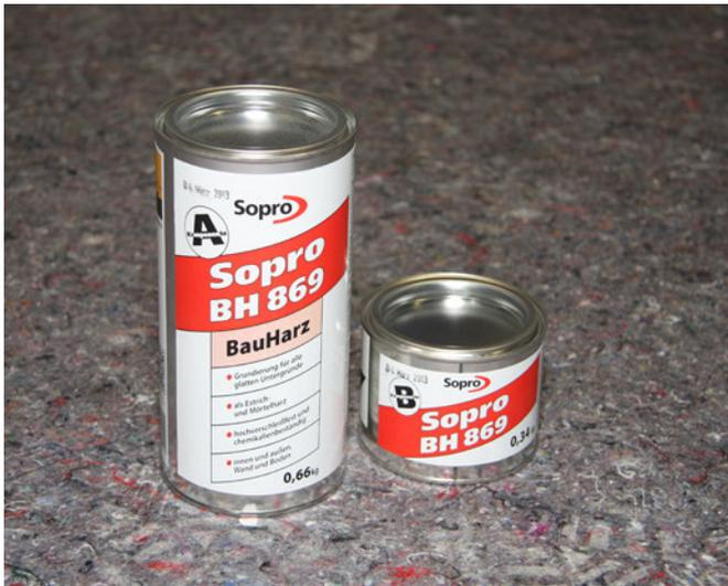
1 Sopro BauHarz Komponente A und B werden im abgestimmten Mischungsverhältnis geliefert. 25 kg Sopro EpoxiEstrichKorn werden mit 1 kg Sopro BauHarz angemischt.
